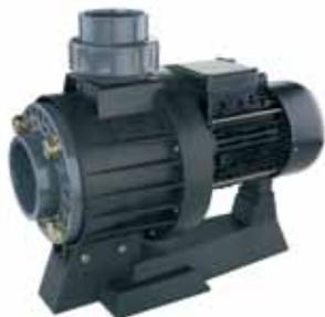
Especialmente diseñadas para equipos contracorriente con elevadas prestaciones de caudal con un mayor diámetro de las conexiones de aspiración e impulsión de la bomba. Es importante no añadir singularidades en la instalación que limiten notablemente estas conexiones. Todos los componentes metálicos de la bomba que están en contacto con el agua están fabricados en acero inoxidable AISI-316 para dar gran resistencia a la corrosión.
