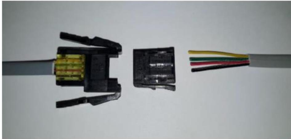
Conexión del cable del panel de control
