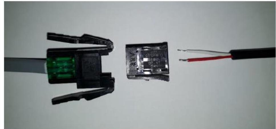
Conexión del cable del sensor de temperatura
