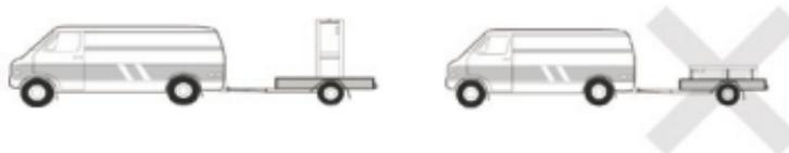
El aparato debe almacenarse y transportarse siempre en posición vertical en un palet y en el embalaje original.
